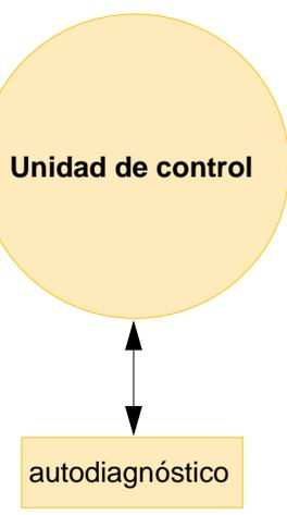
La lógica de acoplamiento de marchas la calcula digitalmente un ordenador en la unidad de control. El mando electrónico del cambio repite constantemente el registro de las señales de sensor, el cálculo de la decisión de acoplar marchas y la emisión a los elementos actuadores. Este ciclo se calcula en 20 ms.
